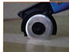
Sélectionner la bande adhésive simplement et sûrement au niveau de la coupe avec le disque tranchant.
